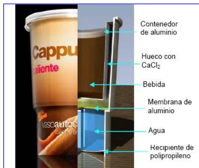
**Figura 6.** Esquema realizado por alumnos de primer curso de Grado universitario de un recipiente para bebida autocalentable. Elaboración propia a partir de un dibujo realizado por alumnos del autor.
